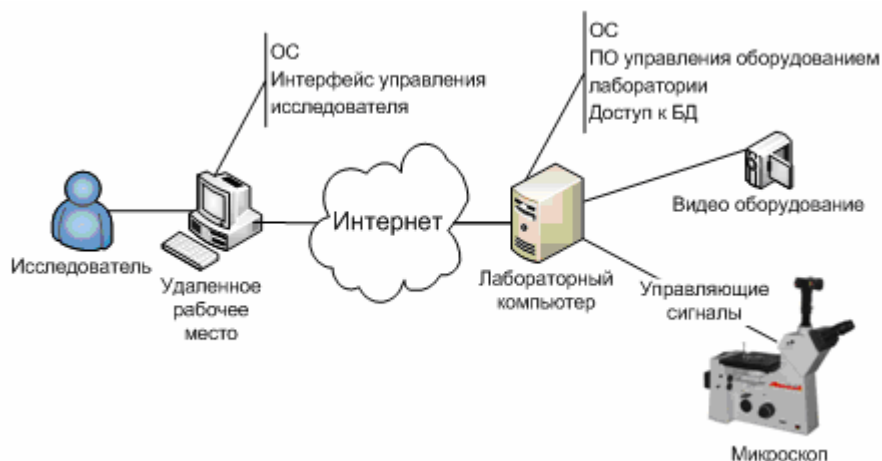
Рис. 1. Схема организации удаленного доступа исследователя к металлографическому микроскопу
