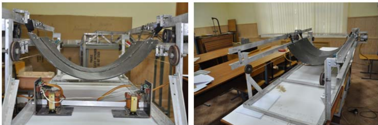
Рис. 1. Экспериментальный стенд для исследования движения дискретного участка ленточного конвейера с подвесной лентой и распределенным приводом
